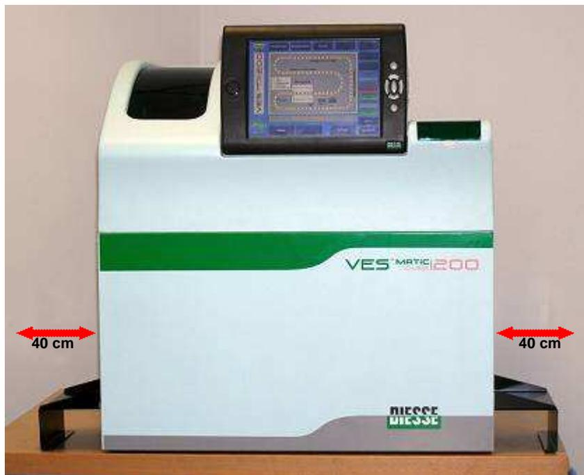
**fig. 2.2.1: vista frontal con prolongaciones para introducción de racks**
