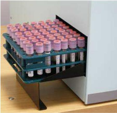
**Fig 2.2.2: lado izquierdo del Ves Matic Cube 200 (rack portamuestras en salida)**
