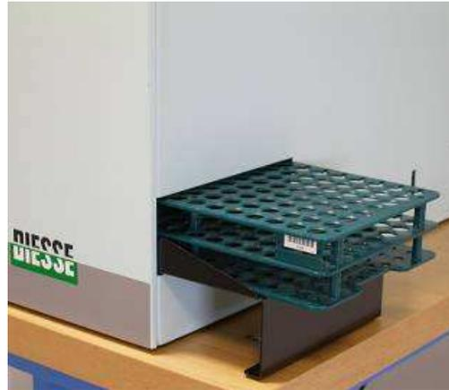
**fig. 2.2.3: lado derecho del Ves Matic Cube 200 (rack portamuestras en entrada)**
