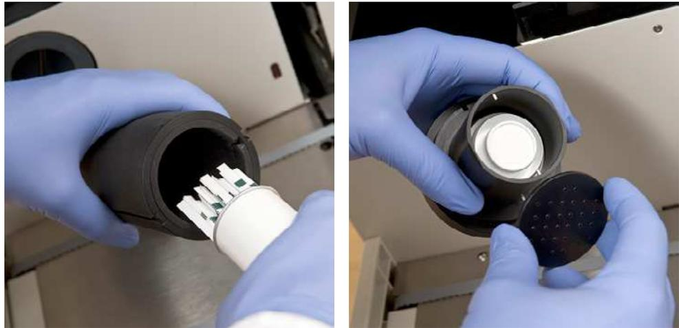
**Figura 19: Carga de tiras reactivas y desecante en el cilindro de carga de tiras**
