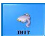
Presione este botón para ejecutar la misma autoverificación que se realiza cada vez que se inicia sesión. Esta función sirve para verificar el estado de todas las partes internas independientes y, una vez ha terminado, inicia UC-MAX. Si experimenta algún problema mientras utiliza el analizador, se recomienda que ejecute esta autoverificación como primer paso para llevar a cabo la resolución de problemas.
