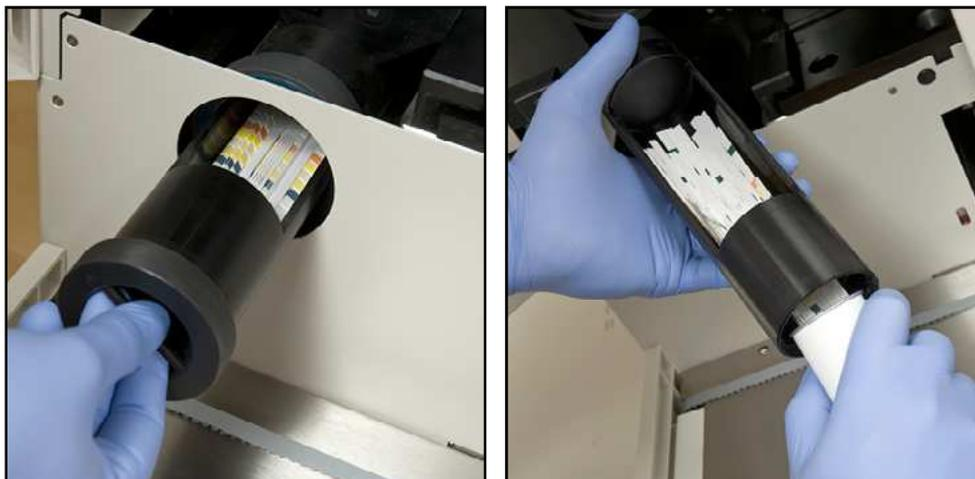
Figura 4: Vaciado del contenedor de tiras sin usar en un frasco de tiras reactivas
