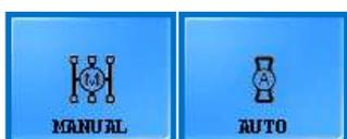
Este botón de dos estados sirve para alternar entre los modos de medición manual y automático (👉 [4.2 Modos de medición](#)). En el modo de medición manual,
