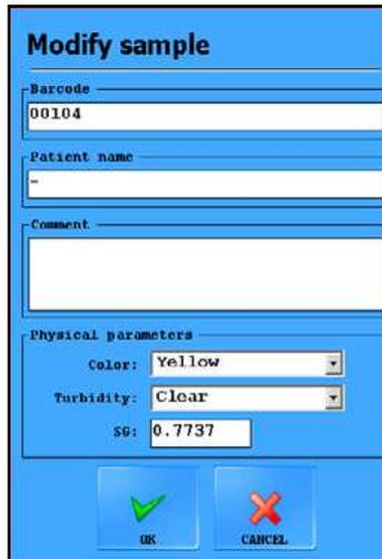
**Figura 6: La ventana emergente Modificar muestra (Modify sample)**
