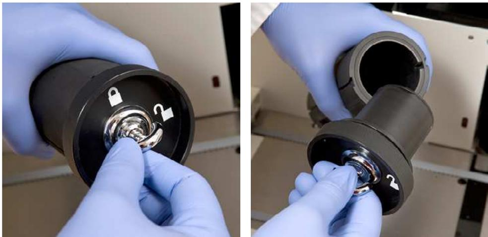
**Figura 18: Apertura del cilindro del cargador de tiras**
